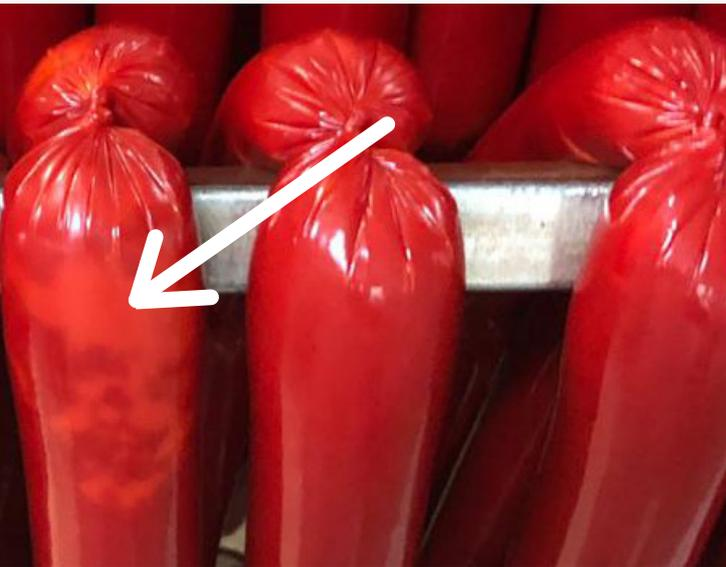
Das Muster mit dem besten Ergebnis wurde gerafft und nach Mexiko versandt, damit der Kunde es mit seinem Brät in seiner Anlage und in seinem Garverfahren testen konnte. Der Darm sah nach dem Garen perfekt aus und sämtliche Brätanteile – inklusive Fett – waren überdeckt. Danach legte der Kunde die Würstchen für 40 Tage ins Regal und überprüfte sie täglich. Die Farbe blieb unverändert und ViskoTeepak erhielt den ersten offiziellen Auftrag über zwei Millionen Meter.
