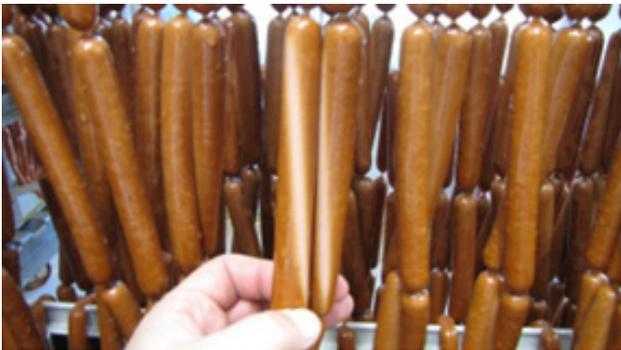
La segunda limitación de la carga es el peso de la varilla cargada. No solo los operarios junto a la máquina embutidora tienen que transportar las varillas cargadas, rellenas desde la cadena transportadora hasta el carro o las líneas de procesamiento automático, sino que el peso final también puede limitar su carga.
