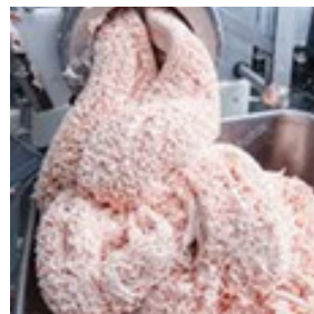
Imagen 2: El picado preliminar a baja temperatura no permite evaluar visualmente la calidad de la grasa a la salida de la máquina picadora.
